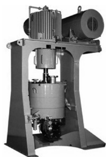
図1 アトライタの外観（左）と内部構造（右）
