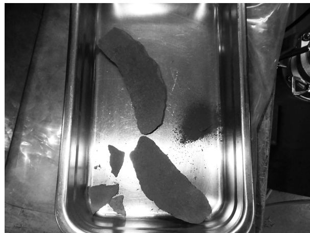
図 6 粉碎室に付着したシリコン系負極材の固着物
