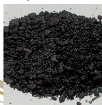
PE pellet+carbon (mixing)
